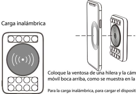
Coloque la ventosa de una hilera y la cámara del teléfono móvil boca arriba, como se muestra en la figura
